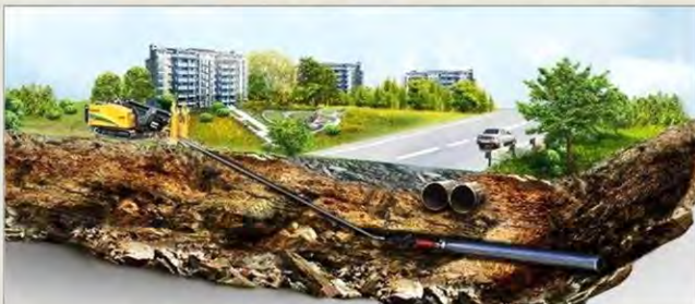
Горизонтально направленное бурение для прокладки инженерных сетей.
