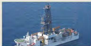
Научно-исследовательское судно «Тикио» способно бурить скважины до глубины 10 тысяч метров ниже уровня моря (фото JAMSTEC/ODP)
