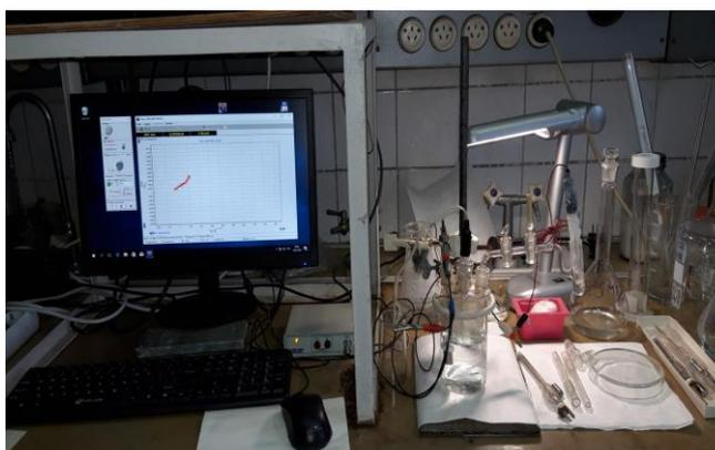
Электрохимические измерения проводили на потенциостате IPC-mtgo с разверткой потенциала со скоростью 10 мВ/с в трех-электродной электрохимической ячейке. Потенциалы на поляризационных кривых приведены от-но хлорсеребряного электрода сравнения.
