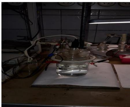
Электрохимические измерения проводили на потенциостате IPC-micro с разверткой потенциала со скоростью 10 мВ/с в трех-электродной электрохимической ячейке. Потенциалы на поляризационных кривых приведены от-но хлорсеребряного электрода сравнения.
