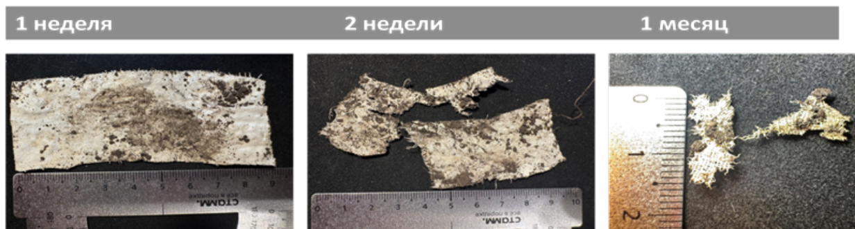
Рис. 1. Макроскопическая картина биodeградации хлопчатобумажной ткани в садовой земле
