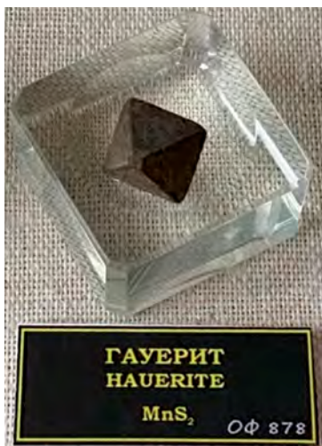
Рис. 2. Кристалл гауерита (коллекция Р. С. Николаева, Музей землеведения МГУ), по которому выполнялись экспресс-определения элементного состава с помощью рентгенофлуоресцентного анализатора.
