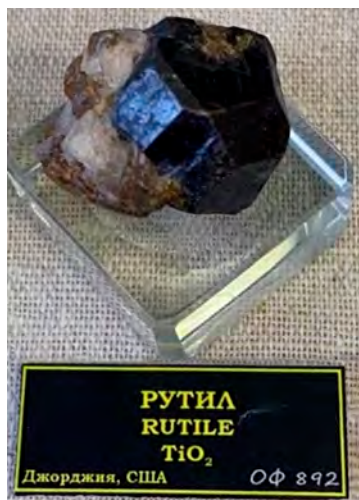
Рис. 1. Образец рутила (коллекция Р. С. Николаева, Музей землеведения МГУ), по которому выполнялись экспресс-определения элементного состава с помощью рентгенофлуоресцентного анализатора.
