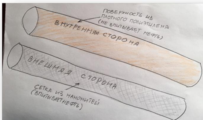
Внутренняя сторона – должна отталкивать и нефть и воду, такими свойствами обладает материал, из которого изготовлены спасательные жилеты для самолетов. Внешняя сторона – наоборот, должна впитывать нефть, может быть даже притягивать ее, но в тоже время, отталкивать воду. Нужными характеристиками обладает изобретенный в США материал из нанонитей, для робота Seaswarm.
